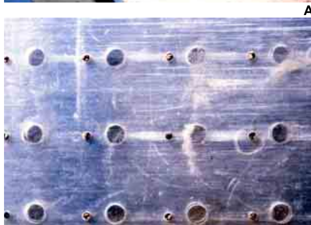
Figura 1.4.25. La sembradora de placa perforada con rejilla móvil ofrece una simple pero efectiva manera de incrementar la velocidad de siembra y la eficiencia. Las cajas se hacen de acuerdo con cada tipo de contenedor (A), con espacios precisos entre perforaciones en la placa (B) que aseguran que el número deseado de semillas sea depositado en cada celda cuando la rejilla se mueve lateralmente (C y D).
