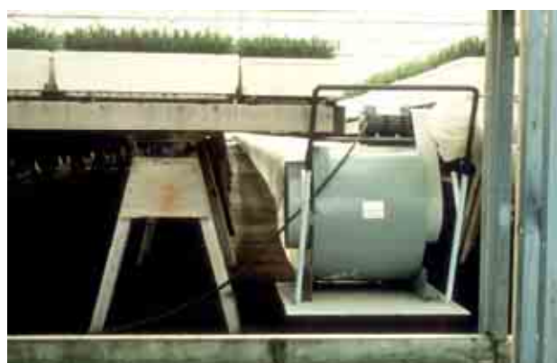
Figura 1.4.3 El equipo de humidificación incluye boquillas o nebulizadores de alta presión (A), mientras que la deshumidificación puede ser complementada con circulación de aire seco bajo las camas (B).
