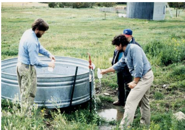
Figura 1.2.3 El primer paso para la determinación del área adecuada para el establecimiento de un vivero, es el coleccionar muestras del agua de riego de todas las fuentes potenciales y obtener su análisis completo.
