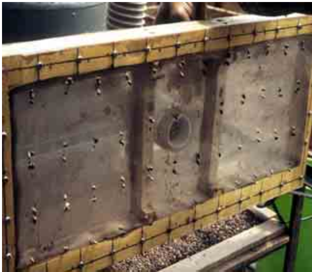
Figura 1.4.26. La sembradora de vacío (A) succiona las semillas y las retiene en la oquedad que coincide con el mismo patrón de la rejilla y las celdas del contenedor. El número de cavidades determina la densidad de siembra (B). Cuando el vacío se interrumpe, el contenedor es sembrado completamente de una sola vez (C). Tanto la caja perforada con rejilla móvil como la sembradora de vacío requieren supervisión, y a menudo se necesita semilla extra para sembrarla en cavidades vacías (D).
