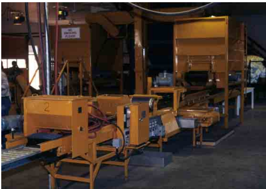
Figura 1.4.23 (continuación) Aunque algunos viveros arman una línea de siembra con equipos diferentes, es posible adquirir líneas completas automatizadas de siembra, de diferentes marcas, para realizar todo el proceso (E).
