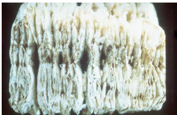
Figura 2.2.11 Las partículas de vermiculita hortícola (A) se asemejan a acordeones, a causa de su estructura expandida de placas paralelas (B), con la que se crea una extensa superficie interna (B, cortesía de Biamonte, 1982).
