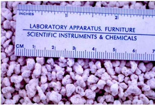
Figura 2.2.12 A causa de su cerrada estructura en celdas, que repele el agua, la perlita es agregada con frecuencia a los medios de crecimiento con el fin de incrementar la porosidad de aireación y el drenaje.
