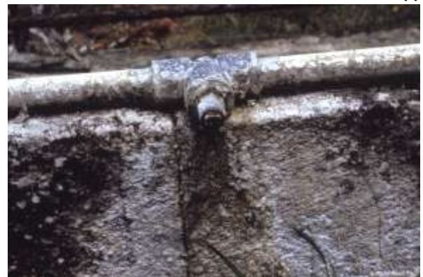
Figura 3.2.11 El agua de riego que será usada para el asperjado o la nebulización, debe ser filtrada o tratada en alguna otra forma para remover los sólidos suspendidos (A), y el agua salina debe ser tratada para prevenir la obstrucción de boquillas o los "depósitos de óxidos" (B).
