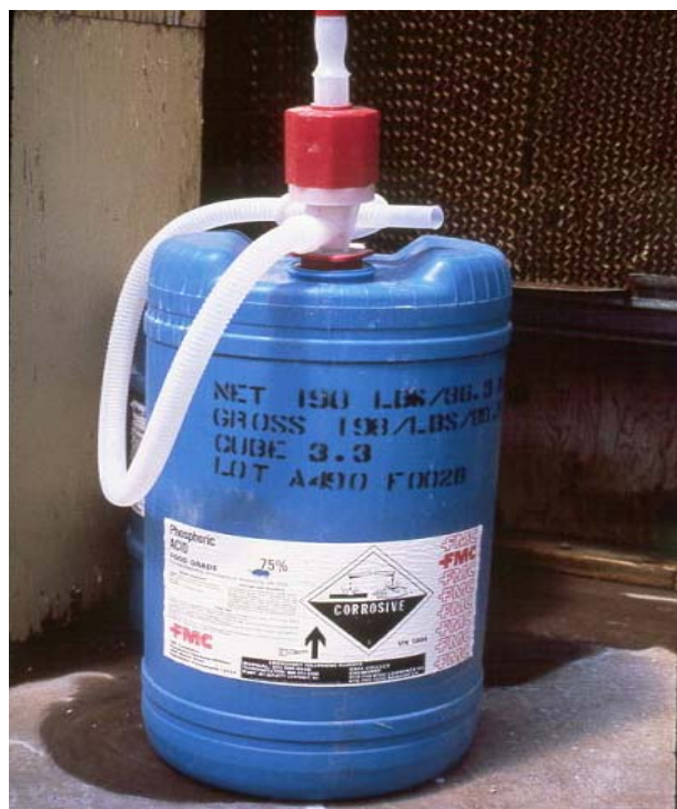
Figura 4.1.10 El ácido fosfórico puede ser una práctica y económica fuente de fósforo cuando también es empleado para acidificar el agua de riego.
