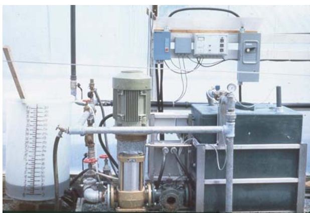
Figura 4.1.16 La inyección de fertilizantes líquidos es un método de fertilización eficiente, pero los inyectores deberán diseñarse para ser compatibles con el sistema de riego.
