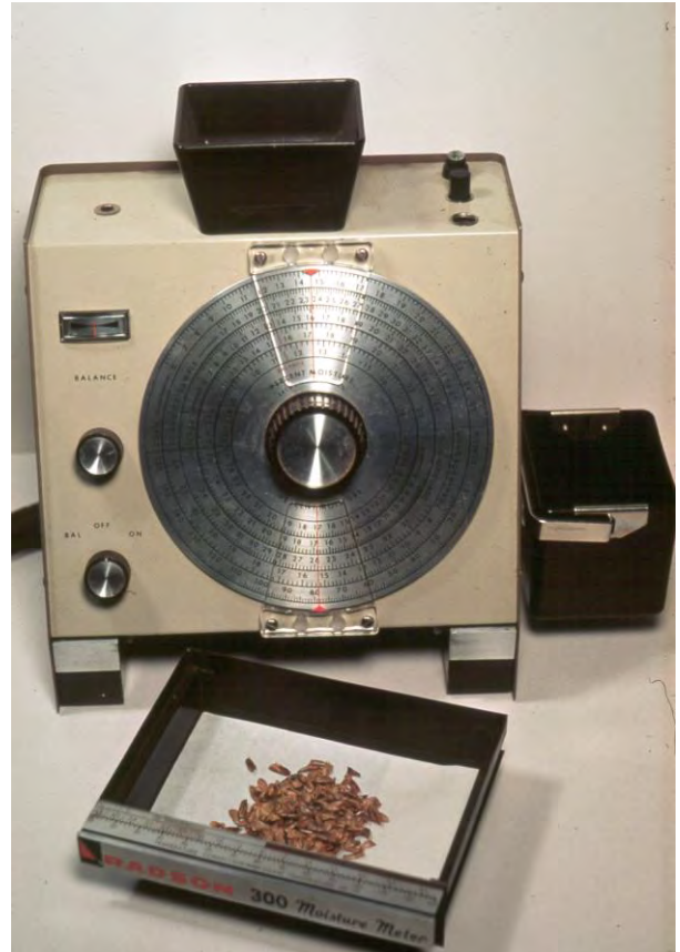
Figura 6.2.13 Medidores electrónicos de humedad pueden proporcionar una medición rápida del contenido de humedad de las semillas si éstos han sido apropiadamente calibrados para las especies (cortesía de R. Karrfalt, Servicio Forestal del Departamento de Agricultura de los Estados Unidos).
